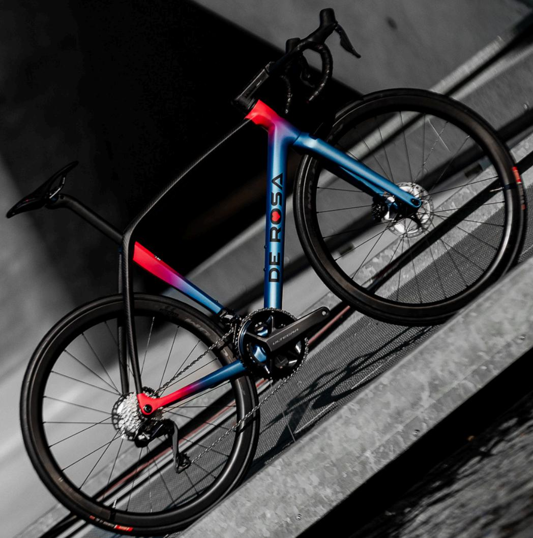
Idol è realizzata in fibra di carbonio ad alte prestazioni, una miscela studiata per garantire rigidità dove necessario e flessibilità dove conta. Un'area del movimento centrale rigida trasferisce ogni watt, mentre i foderi posteriori filtrano le vibrazioni, mantenendo la potenza pura e la pedalata fluida.
